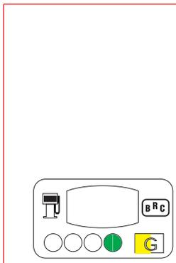
Visualizzazione sul Diagnostic Box della percentuale del valore attuale del reset dello step
