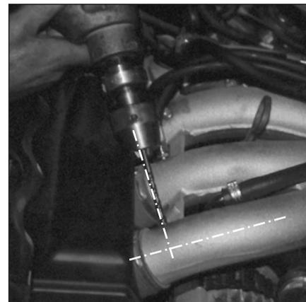
Fig. 31 - Foratura collettore
