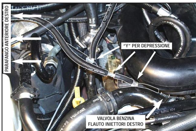
Fissare il gruppo staffa/Smart nella parte anteriore con i fori “C” della staffa, utilizzando le due viti M5x20 con rondelle sui due fori di fissaggio valvola collettore variabile.
