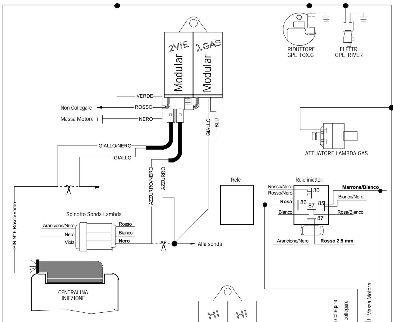
Qualora si desideri eseguire la sovrapposizione dei carburanti installare: N° 1 MODULAR RIT cod. 06LB 0000 3011 in abbinamento alla Centralina Elite, oppure N° 1 MODULAR W-CAB cod. 06LB 5001 0031 in abbinamento alla centralina Windy. Per il collegamento seguire le istruzioni riportate nelle relative confezioni. \* Qualora si installi il MODULAR W-CAB, non è necessario utilizzare il MODULAR STARTEND per l'alimentazione degli HI.
