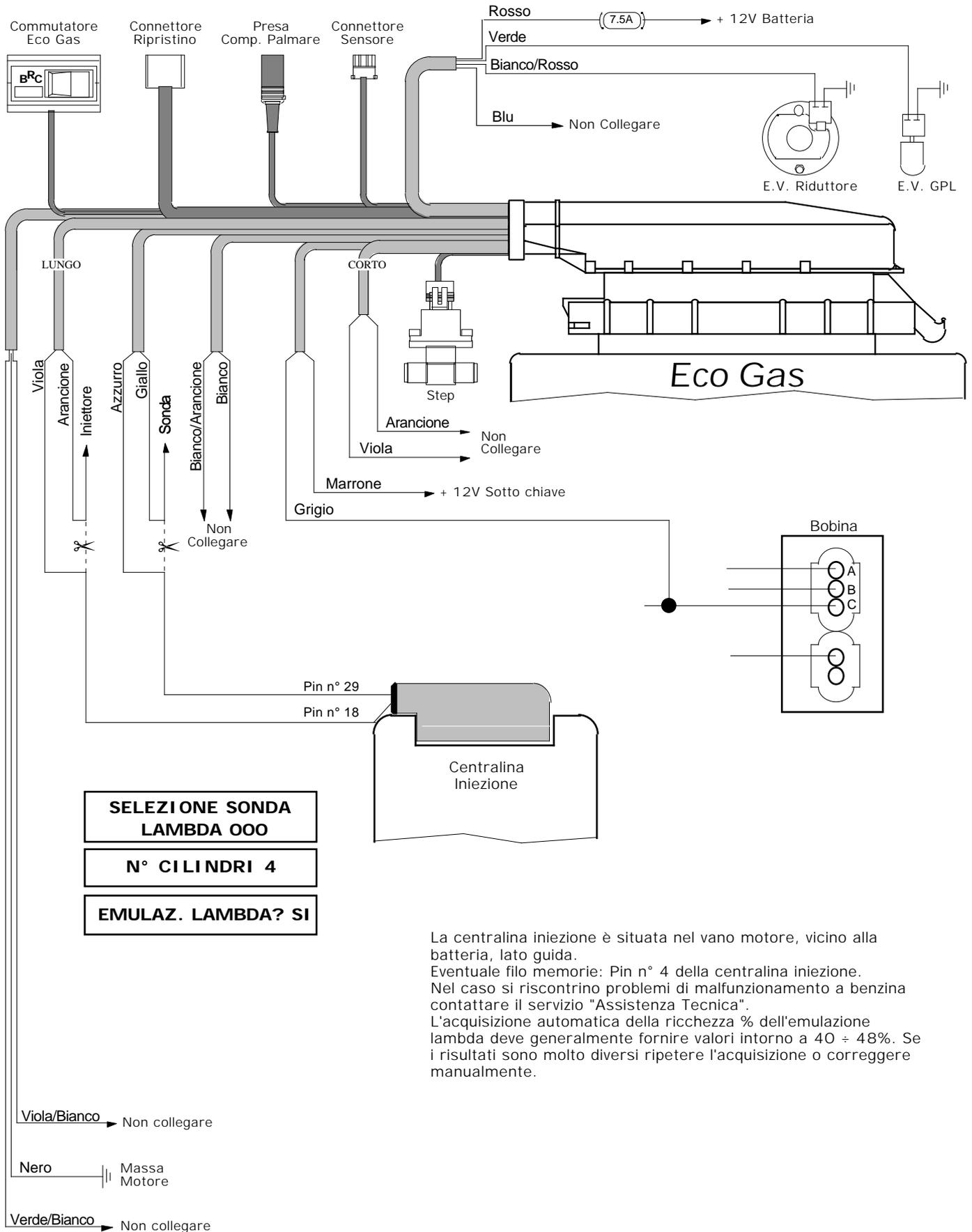
La centralina iniezione è situata nel vano motore, vicino alla batteria, lato guida.
