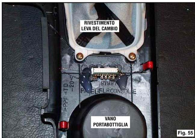
riposizionare la plastica sul tunnel centrale, avendo cura di collegare commutatore e luce del posacenere.
