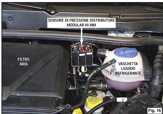
Mediante il bullone TE M6x16, bloccare il gruppo Sensore/Modular HI MM al foro eseguito in precedenza (vedi figura 16).
