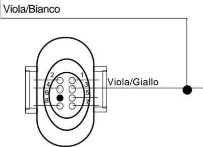
Attenzione: Inserire il Diode 6A sul filo di massa motore. Si raccomanda di orientarlo con la riga bianca verso il bullone di massa e di isolarlo accuratamente.
