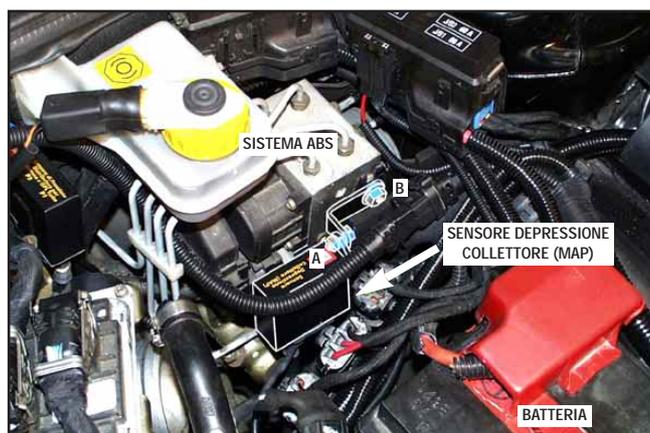
STAFFA DI FISSAGGIO "SENSORE DI PRESSIONE DISTRIBUTORE"
