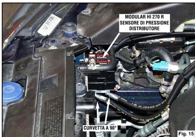
Svitare le due viti TCEI originali di fissaggio flauto iniettori ed utilizzando le asole "B" della staffa fissarvi il gruppo staffa/distributore.
