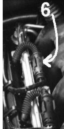
L'auto è dotata di due sonde lambda. Collegarsi alla sonda posta più vicino alla paratia motore (pos. n°6). Il segnale si preleva dal filo nero che dopo la spinetta diventa di colore giallo. Per ottenere un corretto segnale occorre collegare solo il filo viola dell'LCS-A/1V05 e impostare col TESTER PROGRAMMATORE TIPO SONDA →5-0V TIPO A.
