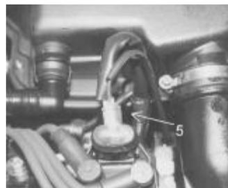
Collegare il filo marrone dell'LCS-A/1 V05 al filo n° 1 di colore azzurro del connettore a quattro fili posto sulla multibobina (pos. 5). oppure al pin n°42 della centralina iniezione (contagiri).
