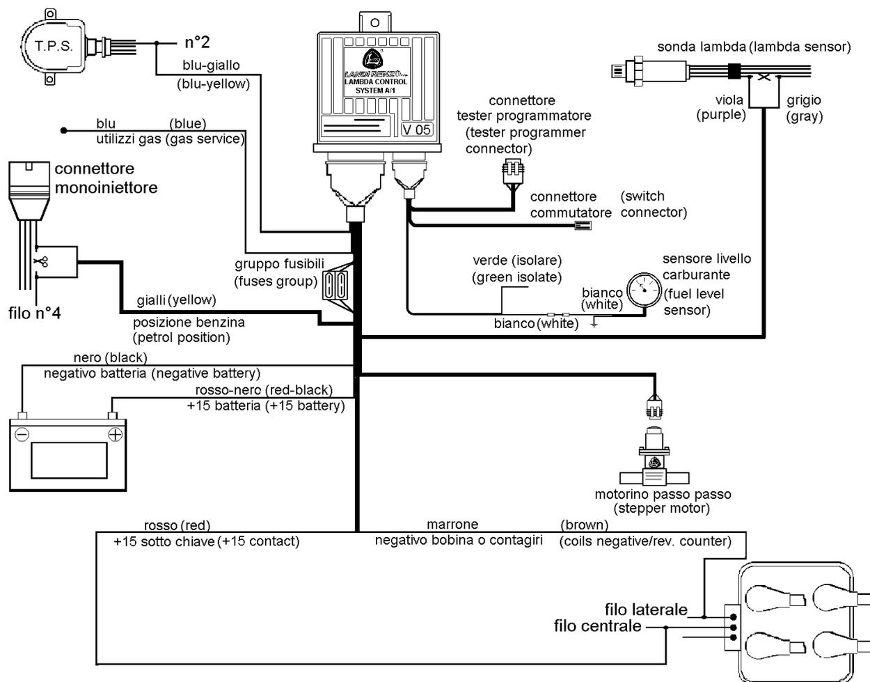
Collegare il filo rosso dell'LCS-A/1V05 al filo centrale del connettore a 3 fili posto sul gruppo bobine d'accensione (pos. n°5), come illustrato nello schema di collegamento.
