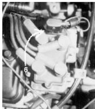
Collegare il filo marrone dell'LCS-A/1 V05 al filo n° 1 di colore bianco marcato 113 del connettore a quattro fili posto sulla multibobina (pos. 6), oppure al pin n°42 del computer iniezione (contagiri).
