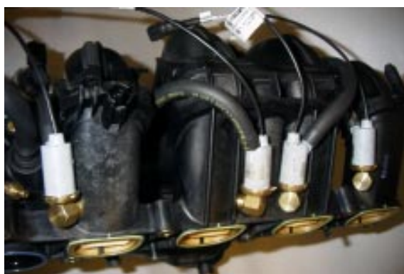
5- Injectorhose / Injectorslangen / Tuyaux d'injecteur cil./ cyl. 1 - 90 cm cil./ cyl. 2 - 85 cm cil./ cyl. 3 - 75 cm cil./ cyl. 4 - 70 cm
