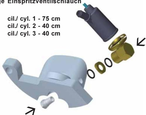
**4. Mounting inletmanifold / Montage inlaatspruitstuk / Montage du collecteur d'admission / Montage Ansaugkrümmer**
