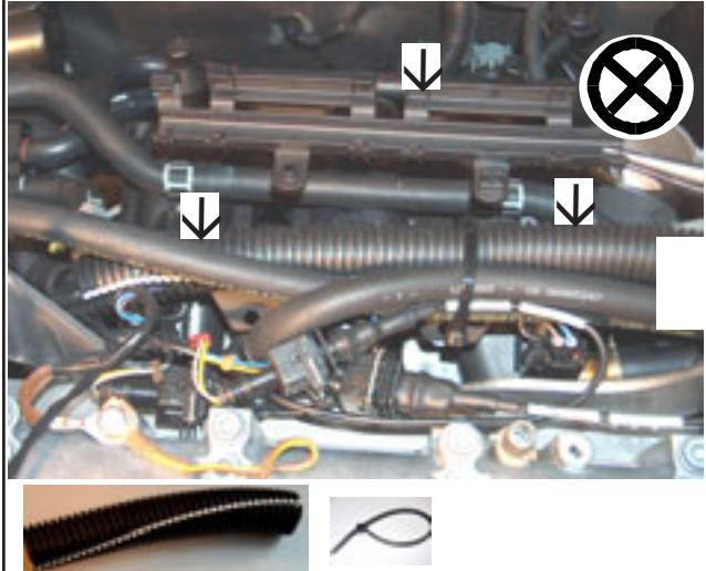
12. Electrical connections / Electrische aansluitingen / Connexions électriques / Elektronische anschlässe
