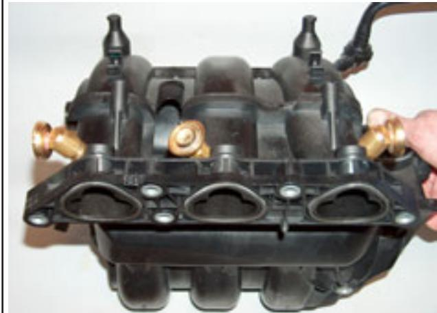
3. Vacuumnipple / Vacuumnippel / Douille à dépression /
