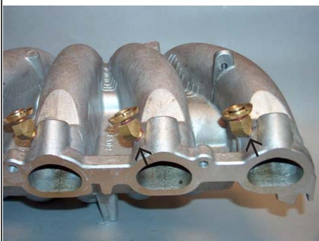
2. Vacuumnipple / Vacuumnippel / Douille à dépression /
