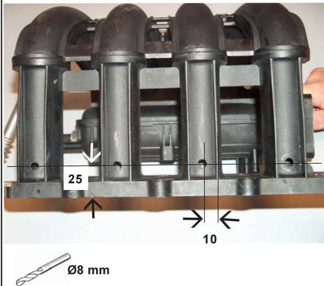
**2. Vacuumnipple / Vacuumnippel / Douille à dépression / Vakuumnippel**
