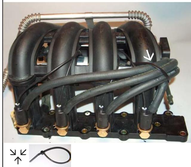
4. Harness leadthrough / Kabeldoorvoer /
