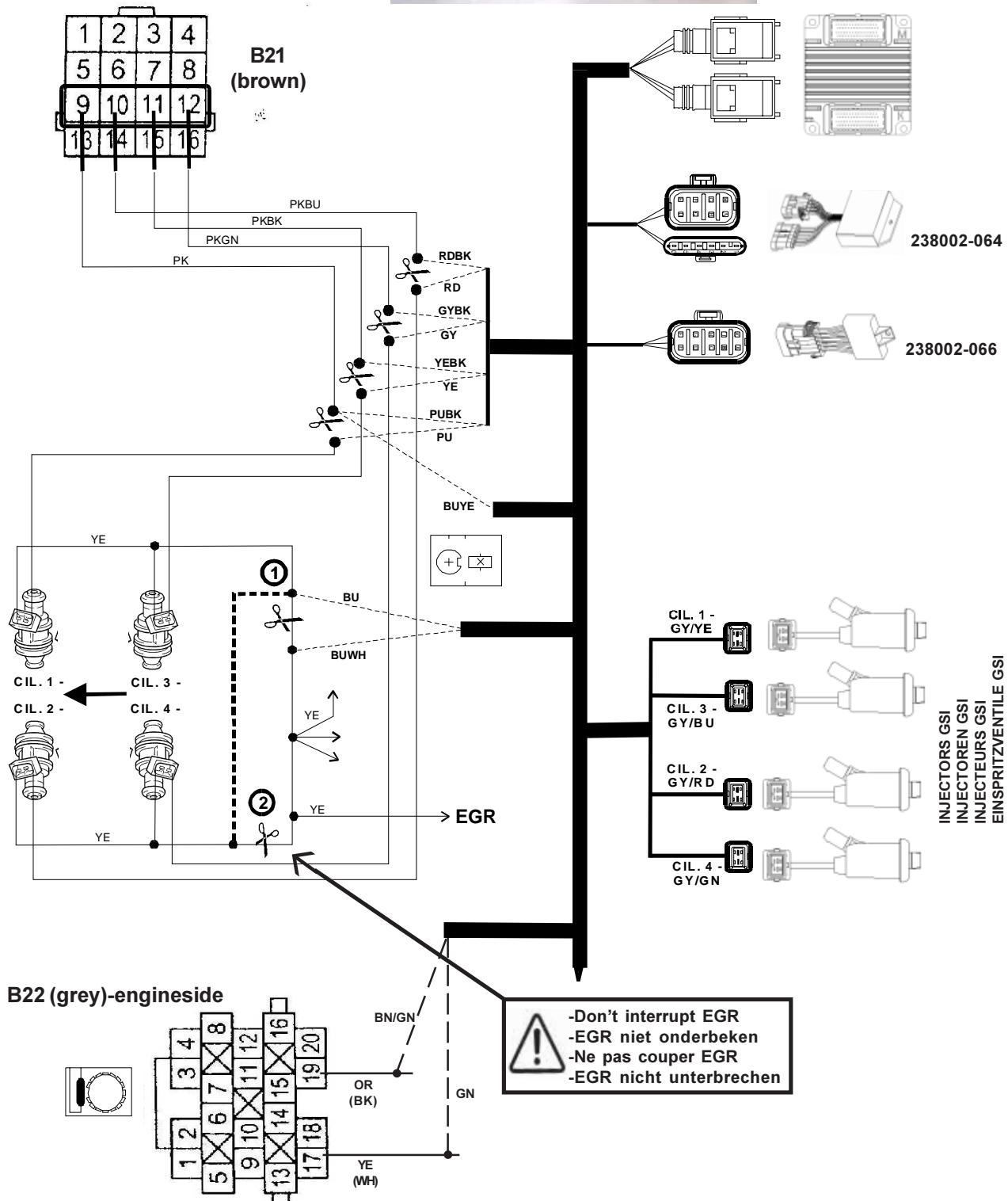
12a. Electrical connections / Electrische aansluitingen / Connexions électriques / Elektronische anschlüsse
