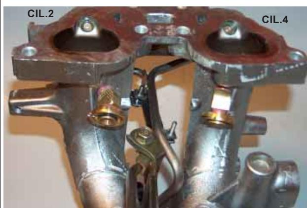
3. Vacuumnipple / Vacuumnippel / Douille à dépression /
