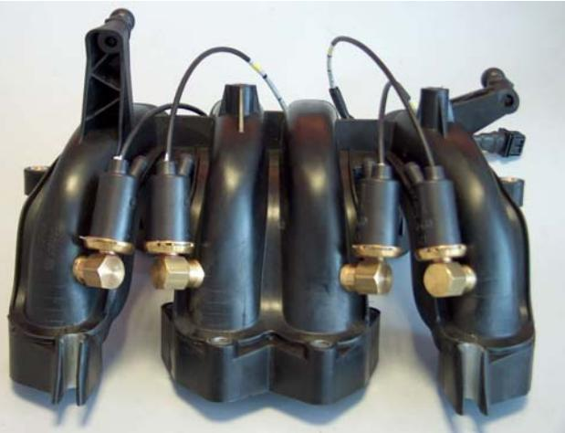
**3. Vacuumnipple / Vacuumnippel / Douille à dépression /
