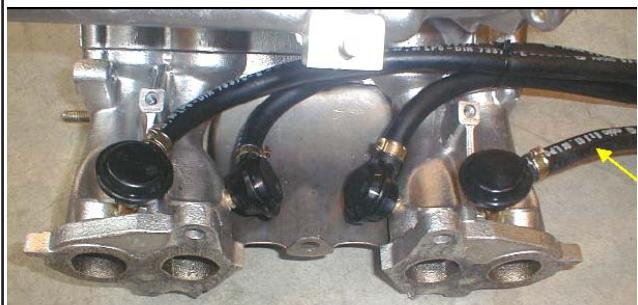
4. Mounting inletmanifold / Montage inlaatspruitstuk / Montage du collecteur d'admission / Montage Ansaugkrümmer
