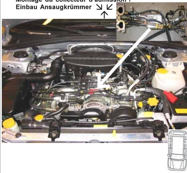
**10. Splitter / Splitter/ Répartiteur filtre/Verteiler**
