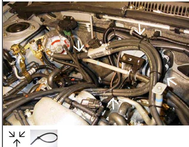
8. Harness leadthrough / Kabeldoorvoer /
