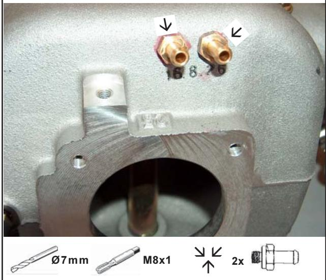
3. GSI-injectors / GSI-injectoren / Injecteurs GSI /
