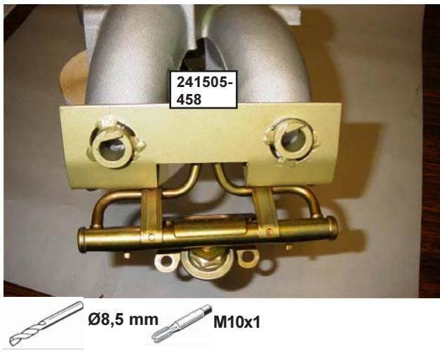
2. Vacuumnipple / Vacuumnippel / Douille à dépression /
