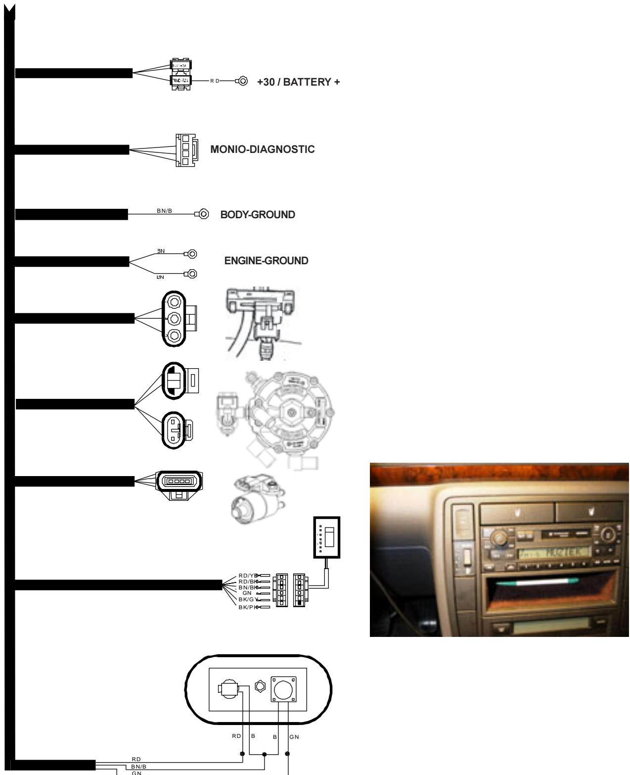
12. Electrical diagram / Electrisch schema / Schéma électrique / Elektronisches Schaltschema
