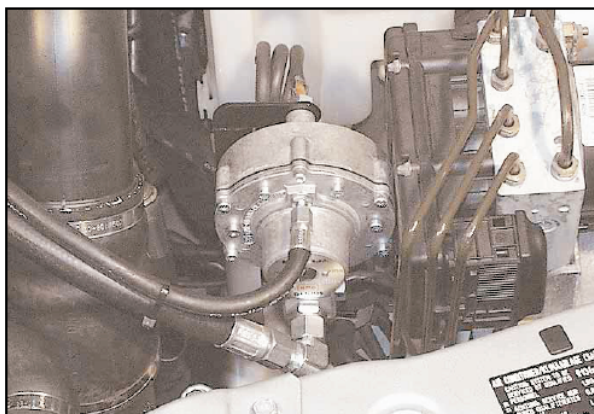
Rys. 27B Montaż reduktora Genius Sequent z membraną prostopadłą do kierunku jazdy
