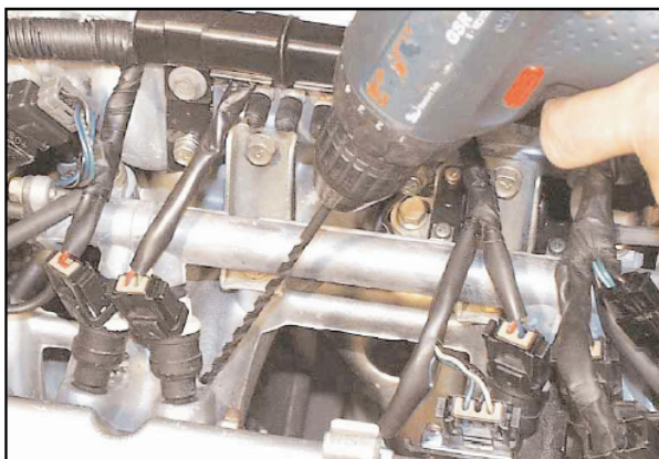
Rys. 37 Wiercenie otworów w kolektorze
