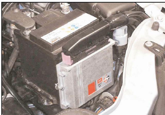
Rys. 43 Montaż centralki w przedziale silnika
