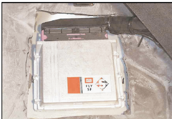
Rys. 42 Montowanie centralki w kabinie kierowcy
