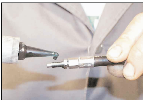
Rys. 40 Środek zabezpieczający gwint przed wykręceniem
