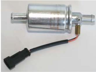
Der integrierte Filter der flüchtigen Gasphase hat solche Abmessungen, die eine leichte und schnelle Montage ermöglicht. Er ist mit einem Filtrationseinsatz hoher Qualität ausgestattet, der in Anlehnung an die neusten Filtrationsstoffe hergestellt wurde. Es wird empfohlen, den Filtrationseinsatz jede 10.000 – 15.000 km zu wechseln. Während der Servicearbeiten soll beachtet werden, damit eine erneute, richtige Temperatursensorabdichtung nach dem Filterwechsel eintritt.
