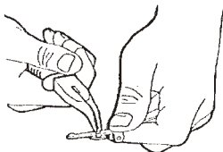
Obrázek 3 montáž sedla 2. stupně
